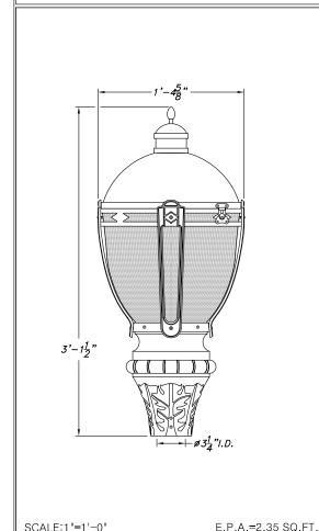
DECORATIVE CAST ALUMINUM CON-1D LID W CAST ALUMINUM FINIAL QUICK RELEASE BUTTERFLY CATCH (2 @ 180°) DARK SKY ALUMINUM LOUVER ASSEMBLY MOGUL OR MEDIUM ACV
