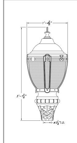
DECORATIVE CAST ALUMINUM CON-1C LID w CAST ALUMINUM FINIAL QUICK RELEASE BUTTERFLY CATCH (2 @ 180°) DARK SKY ALUMINUM LOUVER ASSEMBLY MOGUL OR MEDIUM ACV
